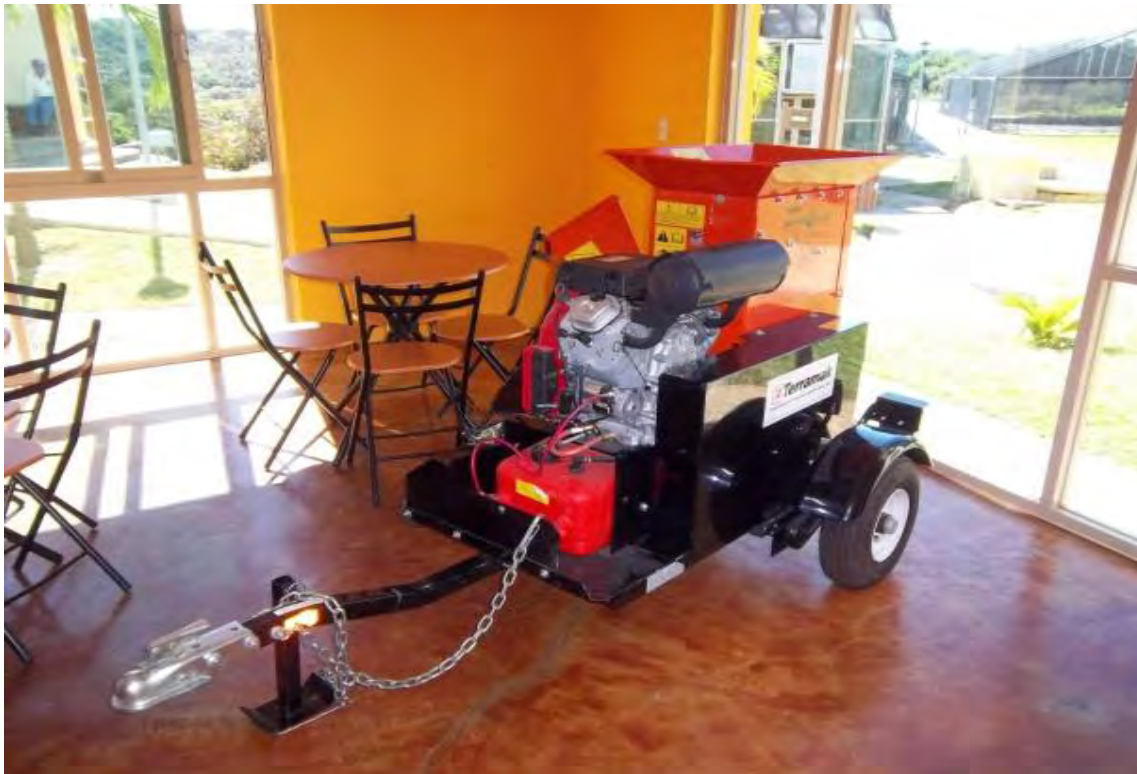
Figura 7. Máquina destrozadora de ramas y residuos de jardinería, que se empleará para la producción de composta.
